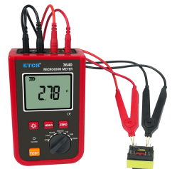
变压器线阻测量
